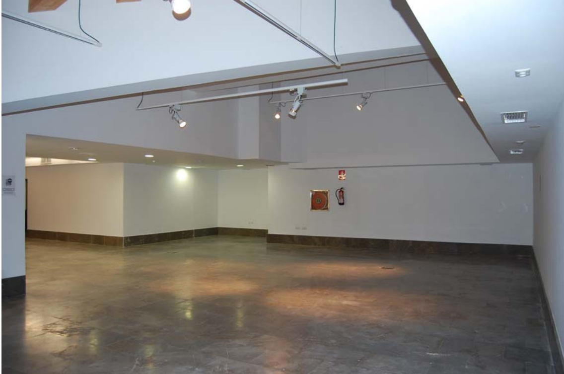
Imagen 23: Vista de la zona destinada al ámbito 3, la zona expositiva. Se observa la iluminación de la misma a través de railes electrificados.
